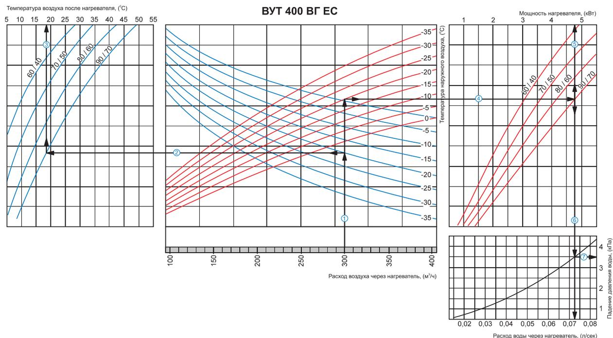
Пример расчета параметров водяного нагревателя:
