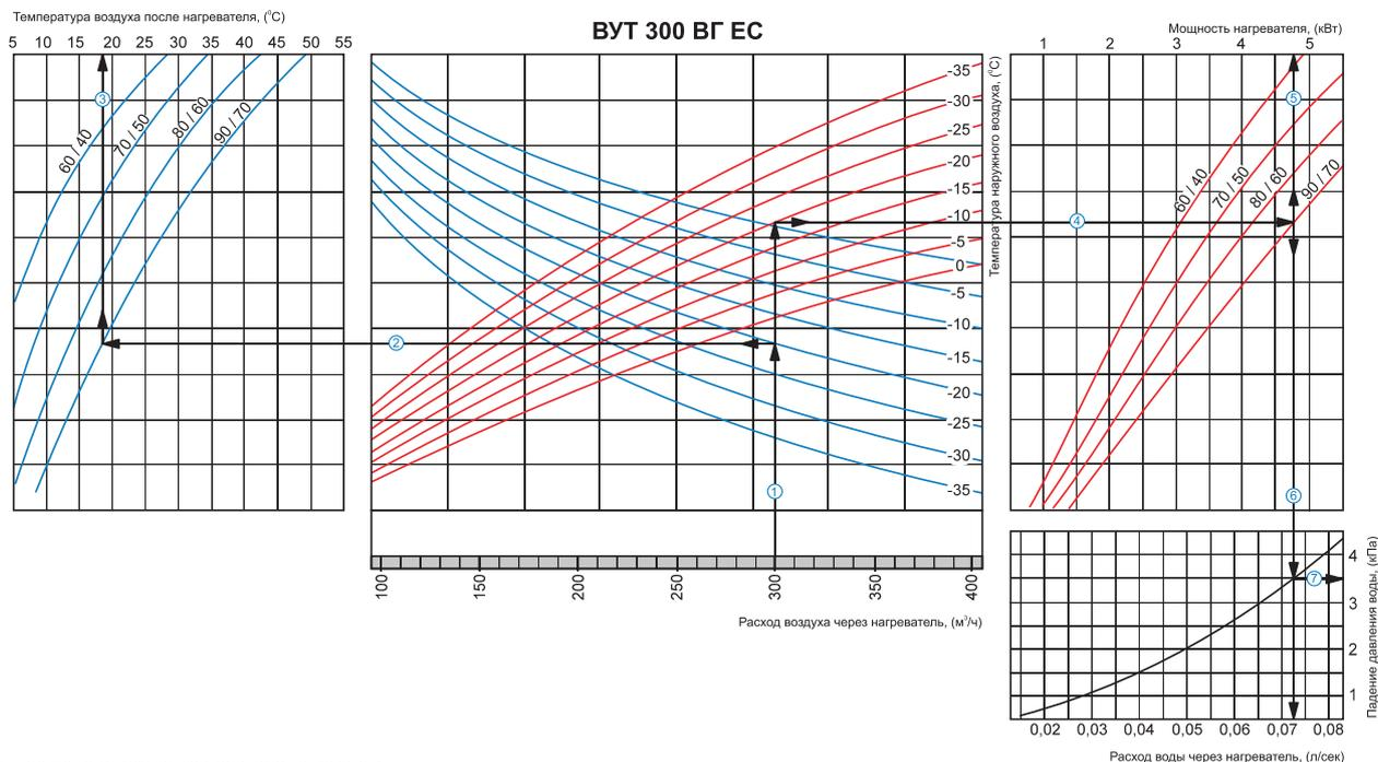
Пример расчета параметров водяного нагревателя:
